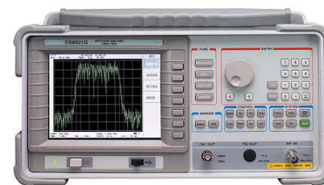
Analizador de espectros. En la pantalla, podemos ver el espectro de una señal.
