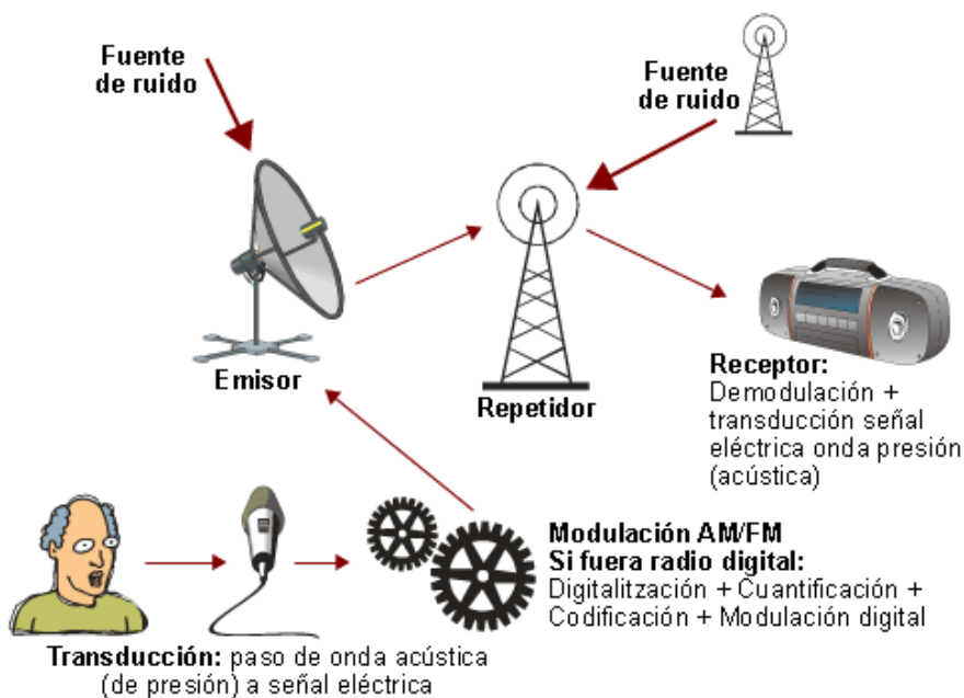
Sistema de telecomunicaciones. Emisión de radio AM/FM o digital.
