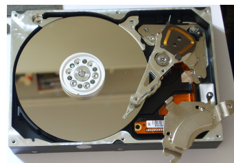
Interior de un disco duro, en el que se muestra el brazo lector/escritor.
