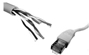
A la izquierda, un tubo de pares trenzados, y a la derecha, un cable con el conector RJ-45 para una red de área local.
